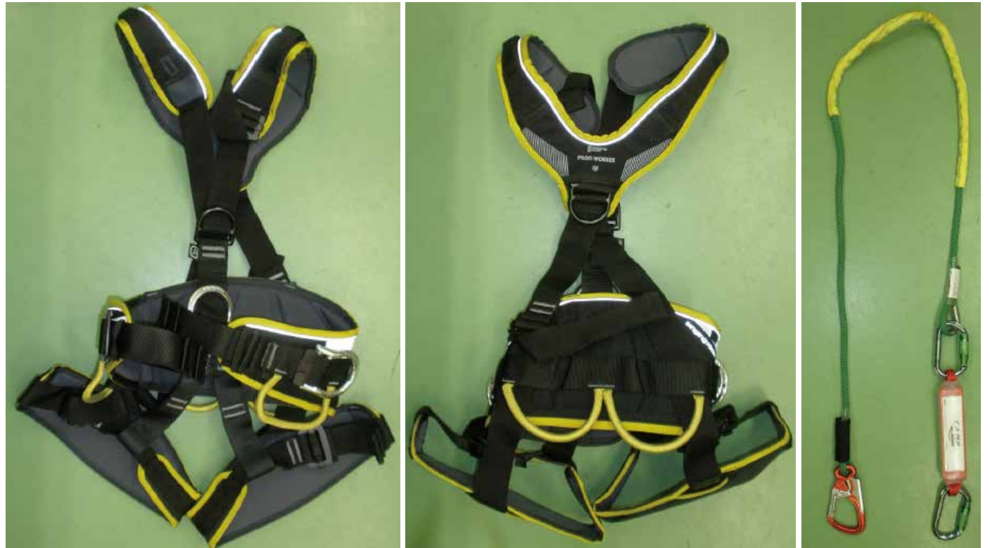
フルハーネスに胴ベルトが付属した「造園用フルハーネス型墜落制止用器具」の前面（写真左）と背面（写真中央） 造園用フルハーネス型墜落制止用器具に装着が可能なショックアブソーバ付きの「1本吊りランヤード」（写真右）
